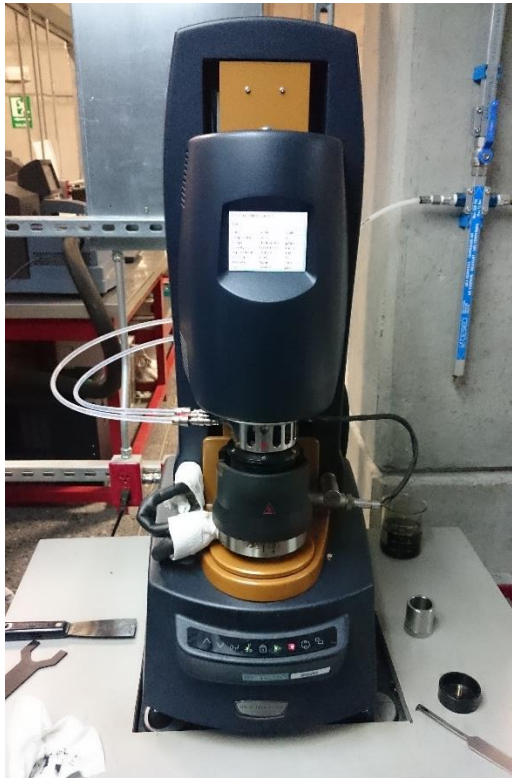
Figura 18. Reómetro de corte dinámico utilizado para las pruebas reológicas, DSR TA Instruments
