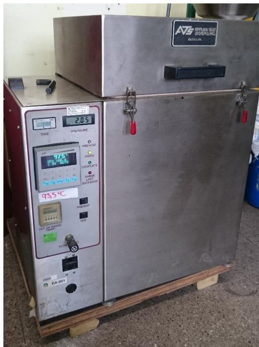
Figura 14. Cámara usada para el ensayo PAV
