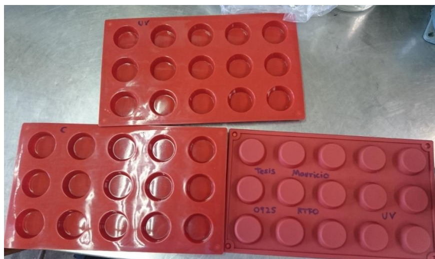
Figura 12. Moldes utilizados para la confección de muestras
