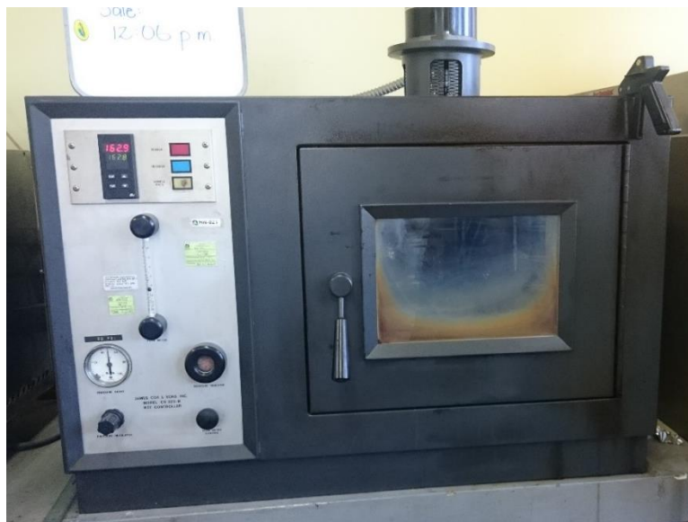
Figura 13. Horno usado para el ensayo RTFO
