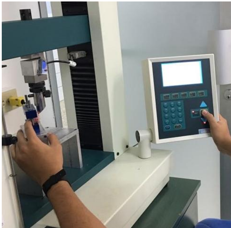
Figura 5. Falla de muestras. Máquina Tinius Olsen H10k-S.
