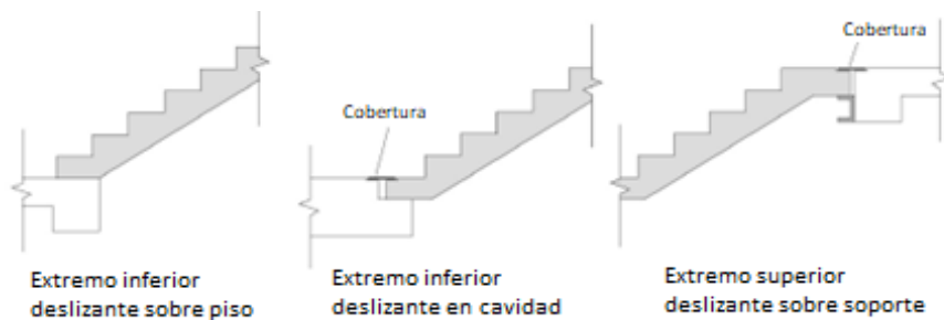
Figura 37. Ejemplos de apoyo en cada extremo de la escalera Fuente: FEMA, 2012 Modificado por: Stalder, 2018
