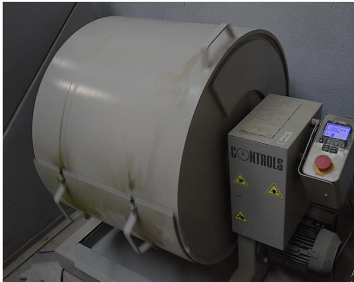
Figura 36. Máquina para el ensayo de abrasión Los Ángeles. Foto de la máquina del laboratorio de Lanamme UCR.
