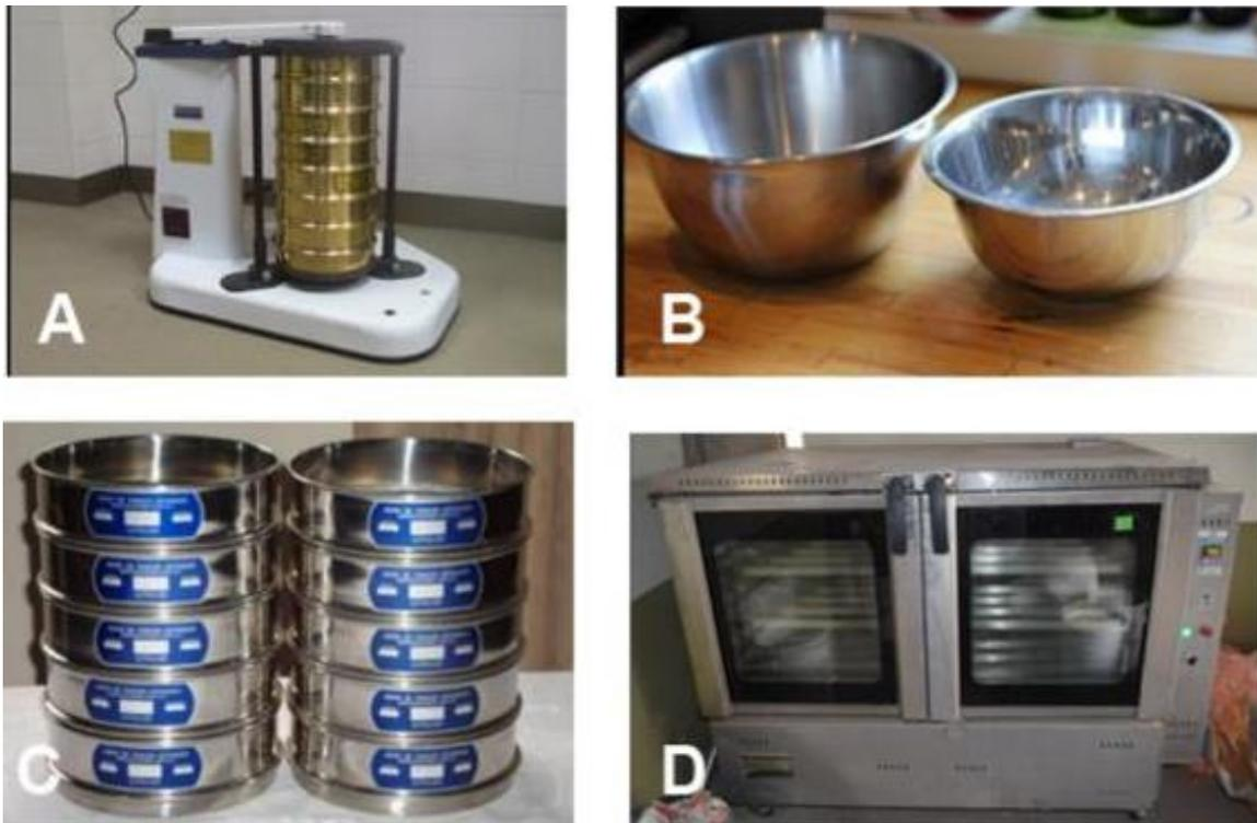
Figura 37. Equipo utilizado en el análisis granulométrico.
