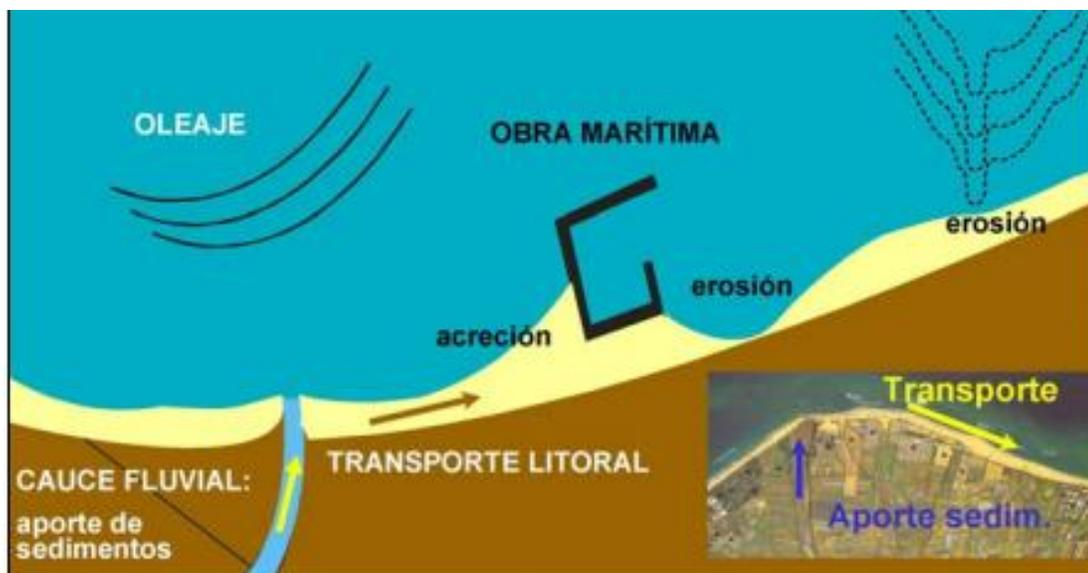
Figura 10. Dinámica costera común y modificación de patrones debido a una obra de infraestructura. Modificado de MITECO (2017).
