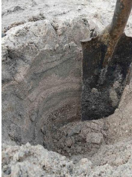
Figura 35. Obtención de la muestra para análisis granulométrico. Se puede apreciar cómo se obtiene una muestra de suelo que trata de incluir los horizontes representativos de la morfología analizada.
