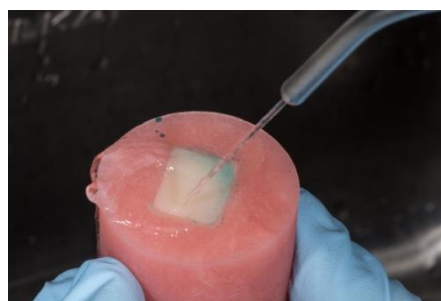
Figura 12. Lavado después de la aplicación de MEP
