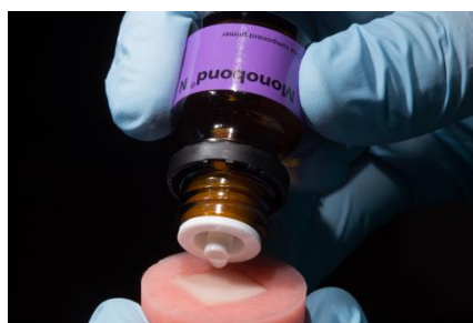
Figura 6. Aplicación de Monobond
