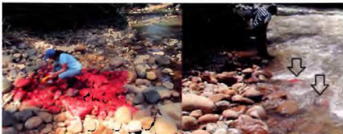
Figura 4-2. Movimiento del sedimento del cuadro 1 en Volcán, entre abril y mayo 2014 (Izquierda, demarcado del cuadro, derecha, observación de la muestra mayo 2014)
