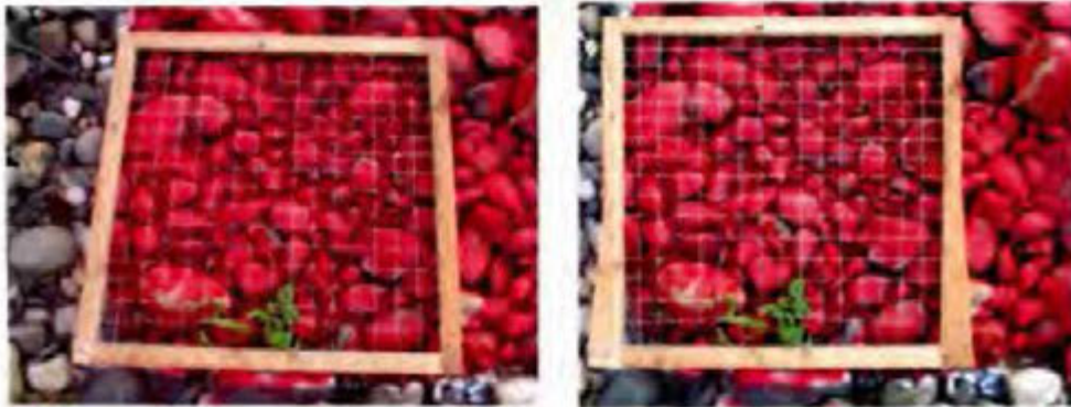
Figura 2-21: Corrección de deformación de fotografía para determinar el tamaño de partículas, por medio de un programa (Fuente: Elaboración propia).
