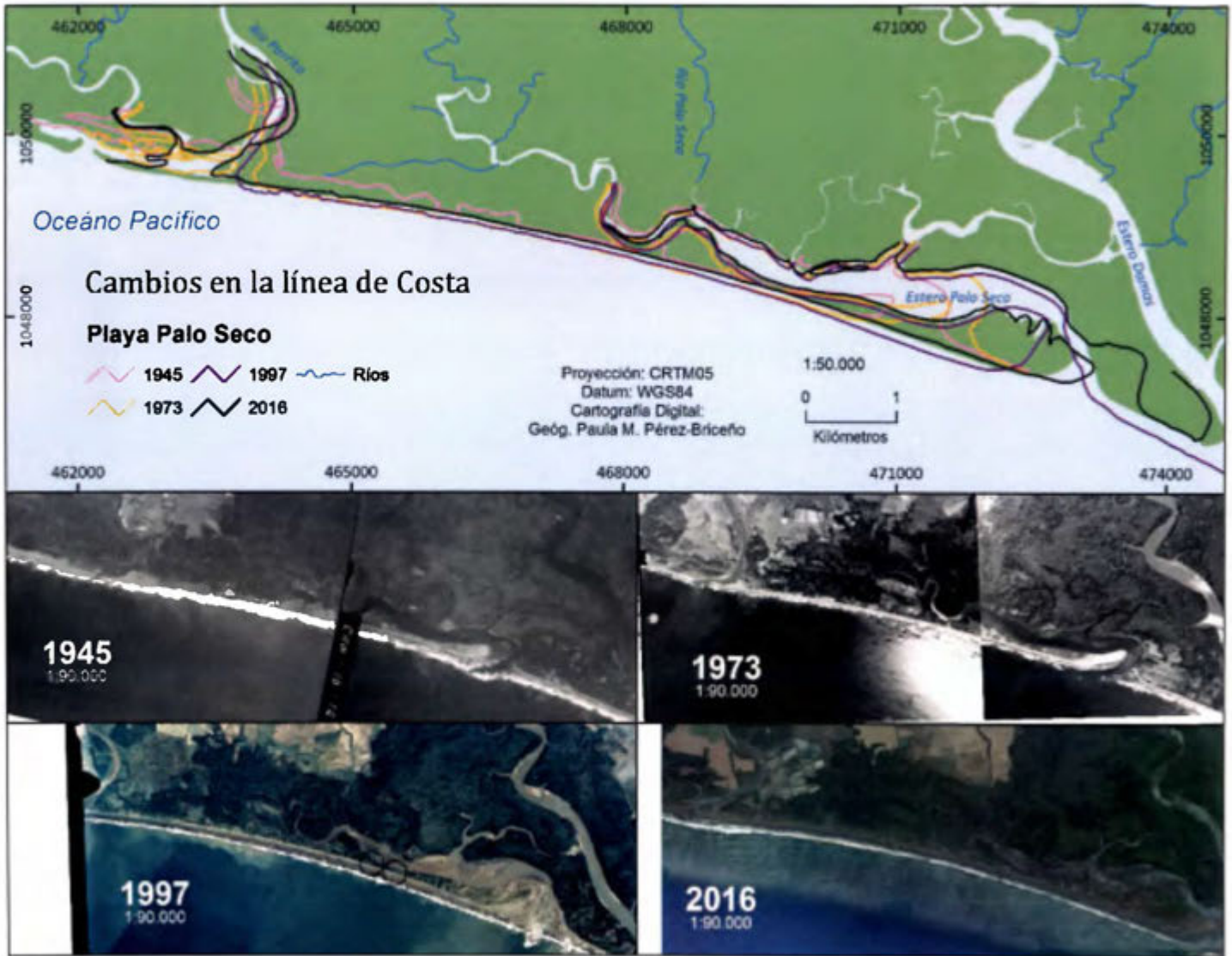
Figura 2-14 Cambios de la línea de costa para Playa Palo Seco entre los 1945 y el 2016 con base en fotografías aéreas.
