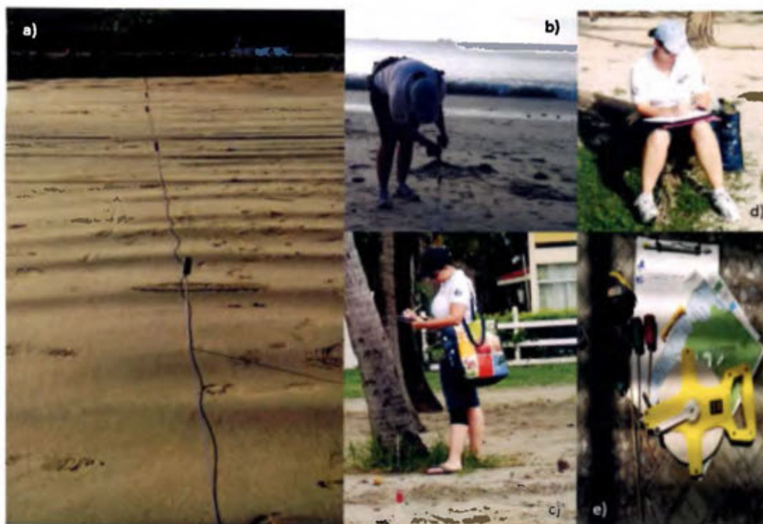
Figura 2-4 Imágenes del trabajo en campo: a) levantamiento de un perfil, b) medición de diferencias de altura entre los segmentos del perfil, c) recopilación información del dispositivo de navegación satelital, d) dibujo de un bosquejo de la playa, e) instrumentos utilizados durante el trabajo de campo.
