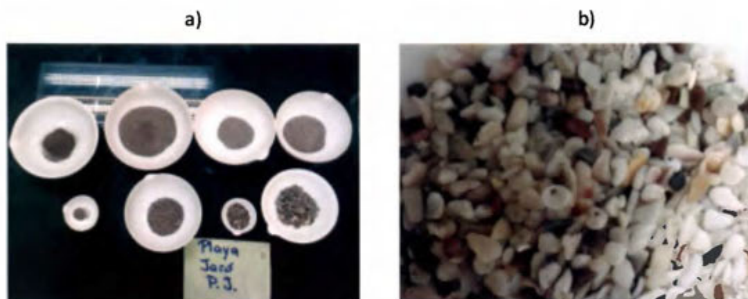
Figura 2-24 Resultado de la granulometría de arenas: a) separación de una muestra húmeda de Playa Jacó según el tamaño del sedimento, b) imagen de granos de arena de Playa Conchal.
