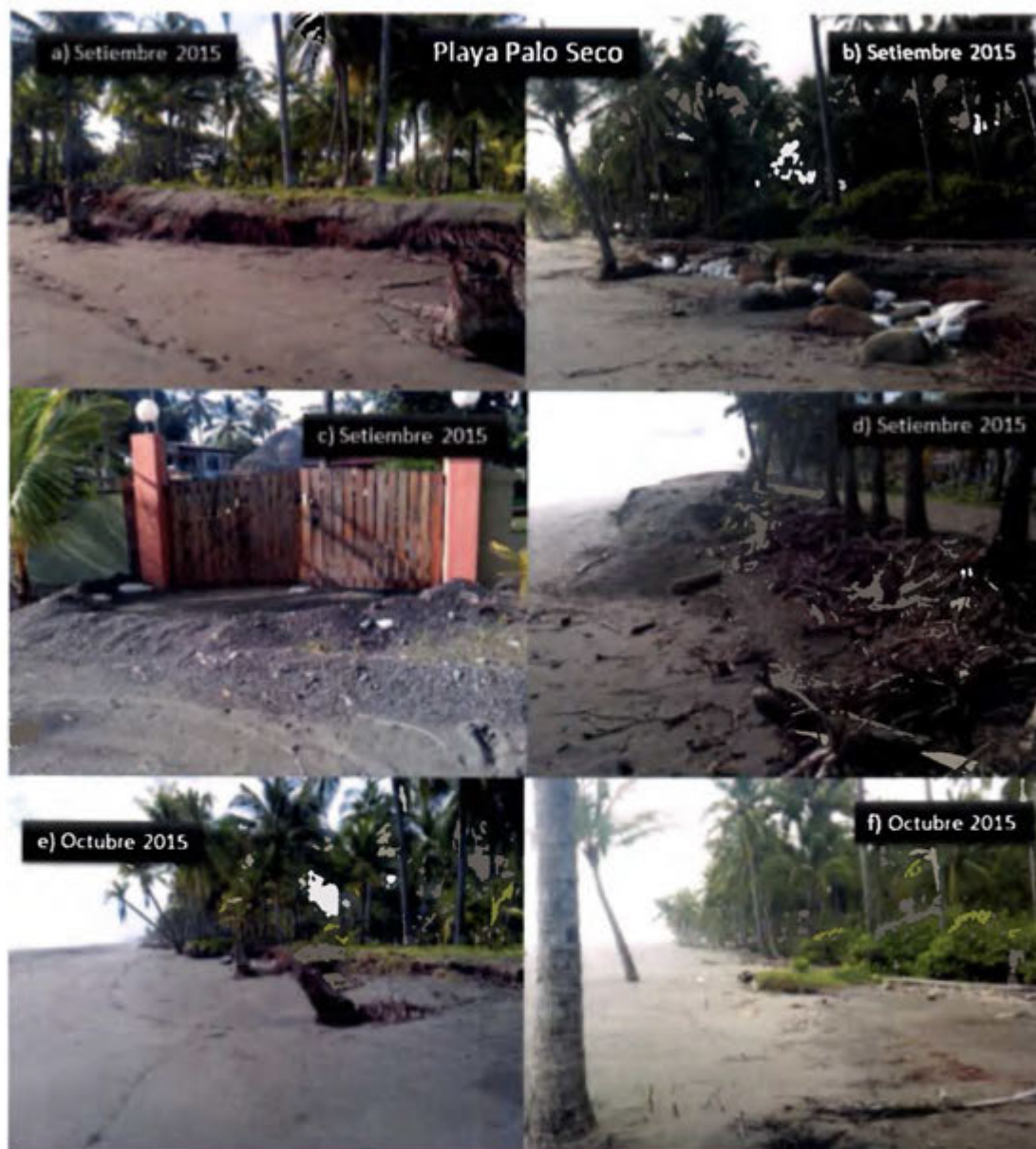
Figura 4-7 Impactos de la erosión en Playa Palo Seco. a) vegetación con raíces expuestas, b) colocación de rocas y sacos de arena para proteger el cordón litoral, c) montículos de arena para proteger la entrada de un hotel, d), e) y f) terrazas de erosión, vegetación con raíces expuestas y destruida en la playa.
