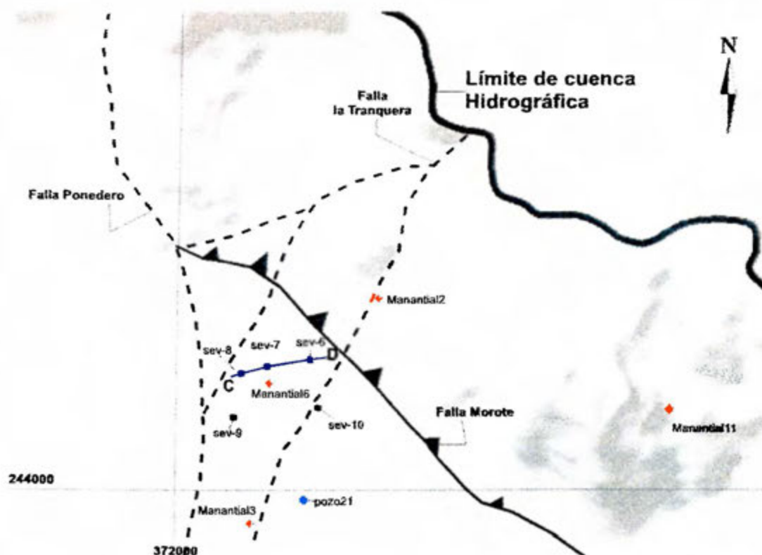
Figura 39. Ubicación de la seudosección eléctrica C-D, entre sondeos eléctricos 6, 7 y 8. Puntos azules pozos de agua subterránea, rombos rojos manantiales, líneas negras discontinuas trazos de Falla, línea negra continua con triángulos (Falla inversa). Esquema sin escala.
