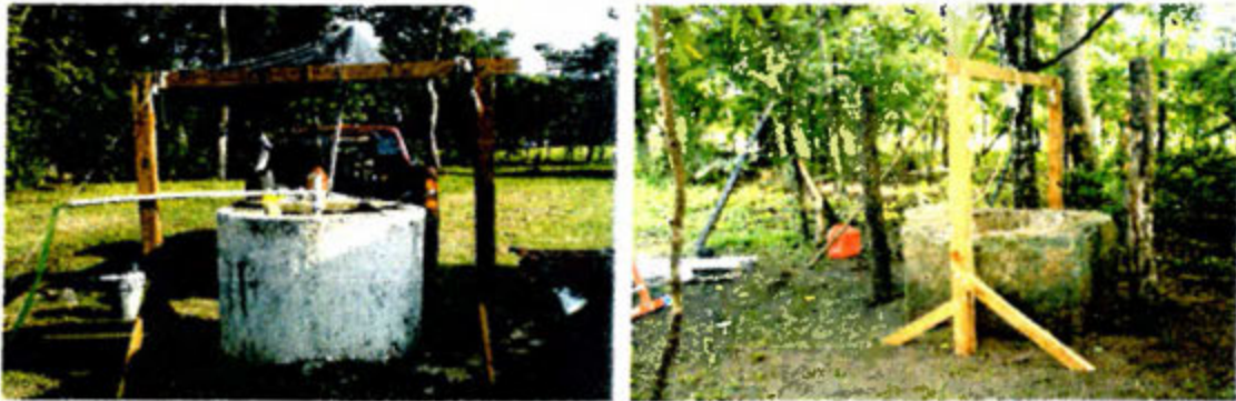
Fotografías 1 y 2. Muestran el marco de madera desarmable donde se colgó la bomba tipo Jet para la ejecución de las pruebas de bombeo en pozos de gran diámetro.
