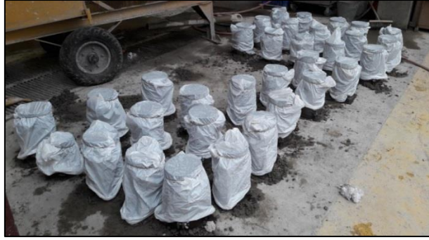
Figura A.21 Ejemplo de cilindros de concreto cubiertos después de moldeo para una mezcla de concreto elaborada
