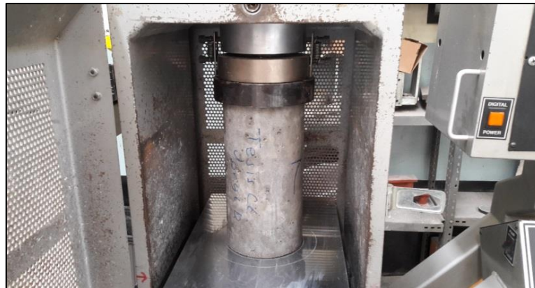
Figura A.29 Ejemplo de alineación de cilindro de concreto en máquina de ensayo a la compresión
