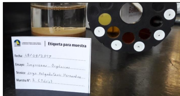
Figura A.4 Ensayo de impurezas orgánicas en agregado fino
