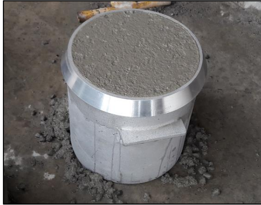
Figura A.23 Ejemplo de espécimen acabado en ensayo de densidad del concreto fresco
