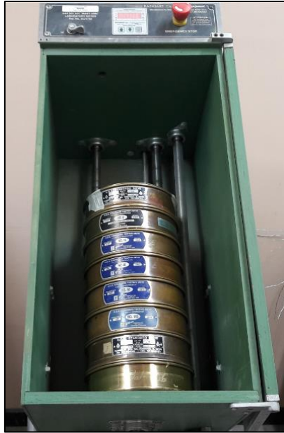
Figura A.9 Tamizadora utilizada para análisis granulométrico de agregado fino
