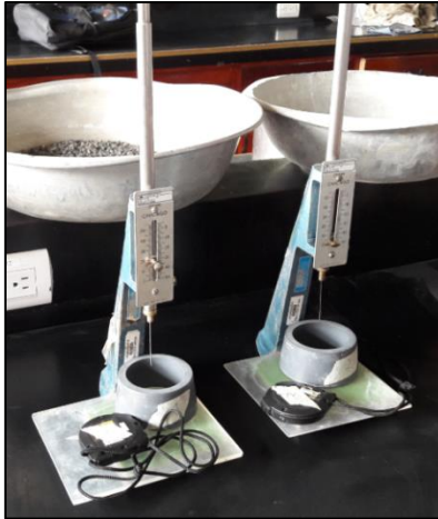
Figura 2.2 Aguja de Vicat utilizada para determinación del tiempo de fraguado
