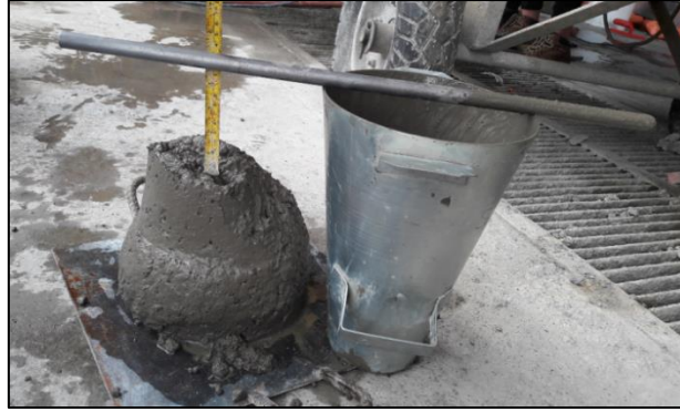
Figura A.24 Ejemplo de prueba de revenimiento para una mezcla de concreto elaborada
