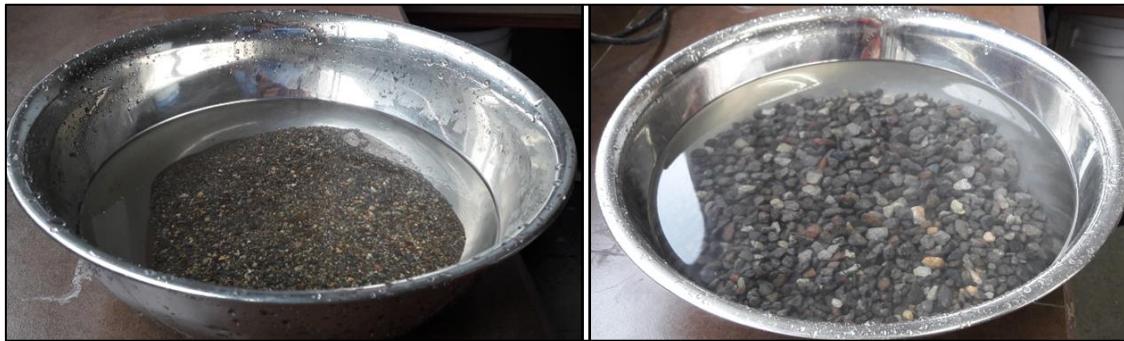
Figura A.5 Lavado de material más fino que la malla No. 200 (agregado fino a la izquierda, agregado grueso a la derecha)
