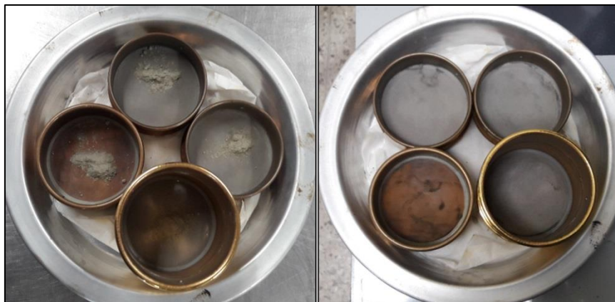
Figura A.19 Muestra de cemento antes (izquierda) y después (derecha) de ensayo de finura
