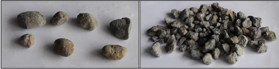
Figura A.10 Partículas no fracturadas (izquierda) y partículas fracturadas (derecha)
