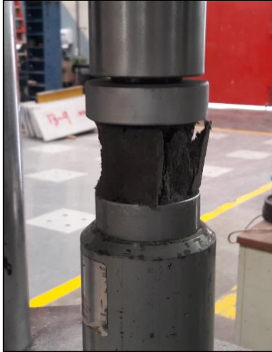
Figura A.15 Aplicación de carga hasta falla en cubo de mortero
