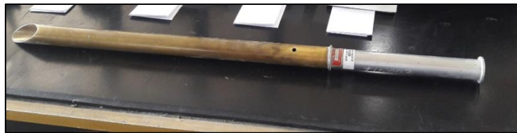
Figura A.13 Tubo de muestra de cemento
