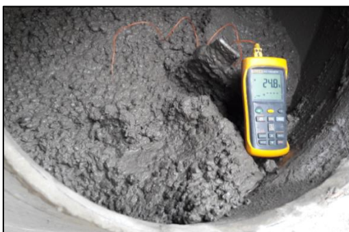
Figura A.26 Ejemplo de medición de temperatura para mezcla de concreto elaborada
