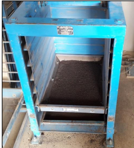
Figura A.11 Agitador mecánico utilizado para corrección de agregado de tajo
