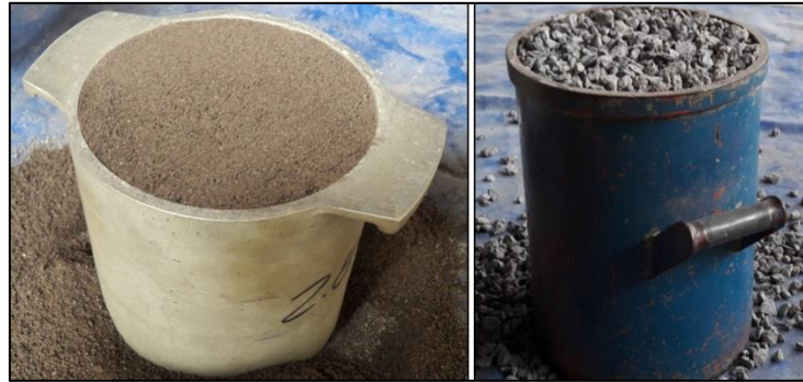
Figura A.3 Nivelación de superficie de muestras ensayo de densidad masiva (agregado fino a la izquierda, agregado grueso a la derecha)
