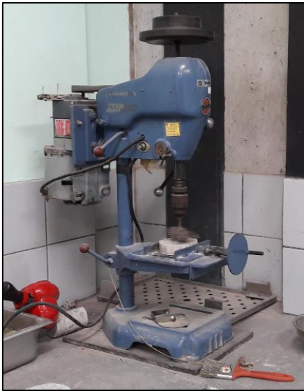
Figura A.32 Ejemplo de ensayo en ejecución de corte rotativo en espécimen de concreto
