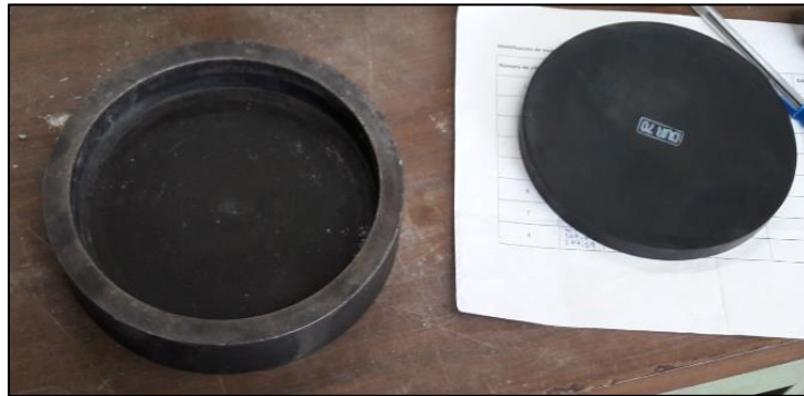
Figura A.28 Ejemplo de retenedor y almohadilla de neopreno utilizados
