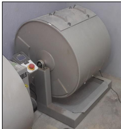
Figura A.8 Máquina de Los Ángeles utilizada en el desarrollo del proyecto
