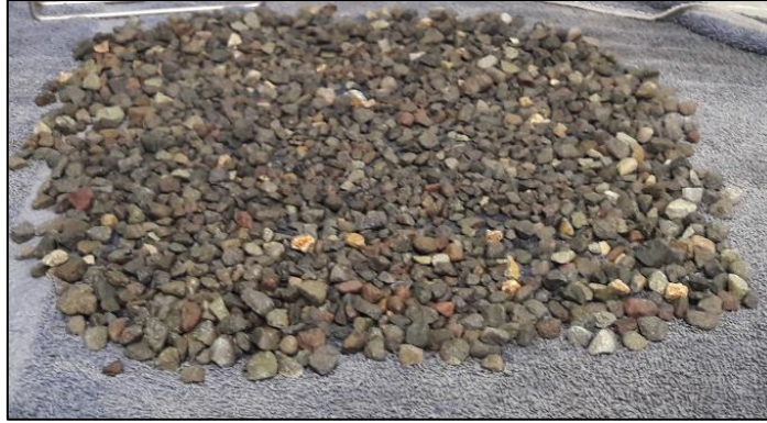
Figura A.6 Condición saturada superficie seca en agregado grueso
