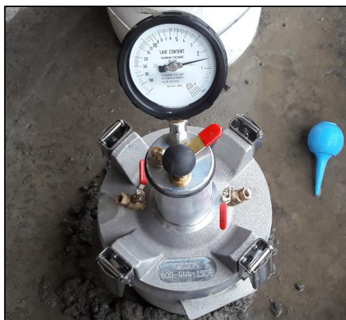
Figura A.25 Ejemplo medición del contenido de aire para una mezcla de concreto elaborada
