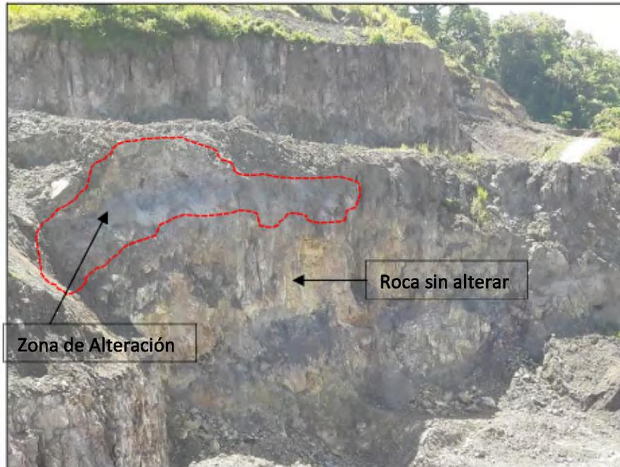
**Figura 3.6** Muestra la cara de la berma que fue prospectada como verificación de lo observado en los resultados de la sísmica además de identificar las velocidades promedio para cada material.
