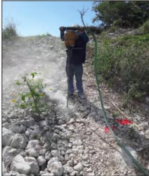
**Figura 3.2** Muestra el proceso de perforación realizado para el uso de explosivos como fuente generadora.
