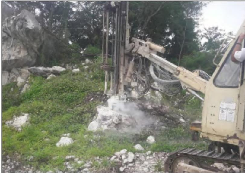
**Figura 2.1** Muestra la perforación de un hoyo utilizando una perforadora TH, Top Hammer o martillo de cabeza.
