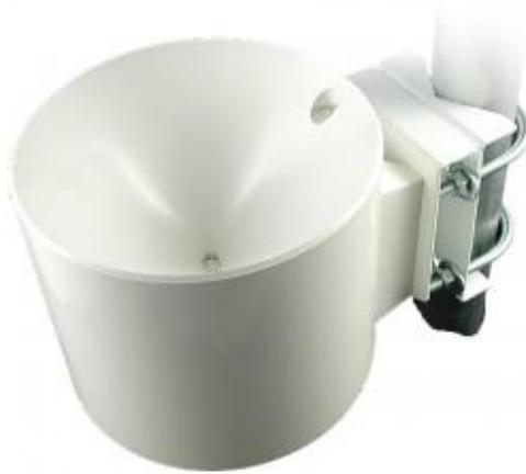
**Figura 11.** Pluviómetro ECRN-100 utilizado en el experimento para medir volúmenes de drenaje.
