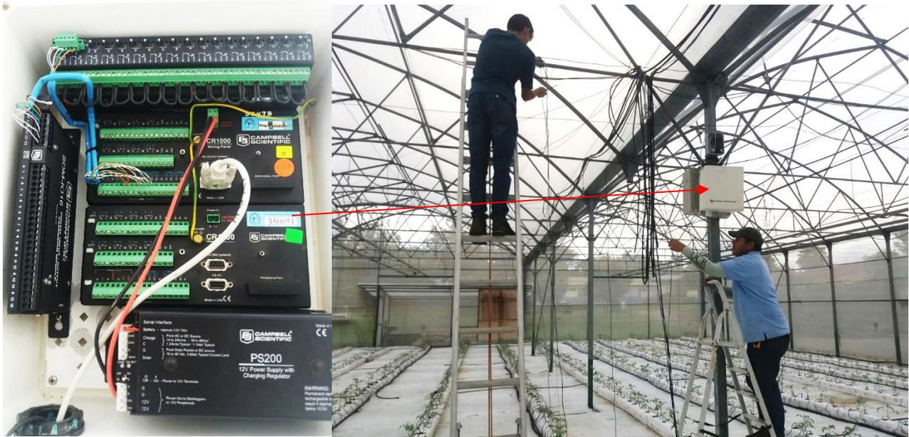
**Figura 16.** Controlador y registrador de datos (CR1000) y conexiones e instalación del cableado eléctrico, cada cable representa una conexión con cada una de las parcelas de investigación de forma independiente.
