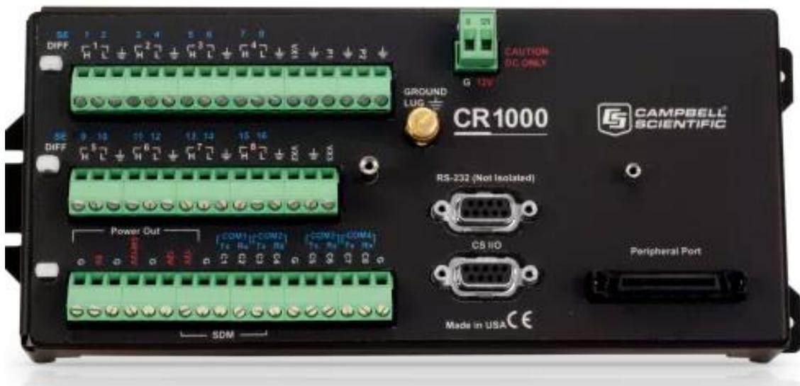
**Figura 12.** Registrador de datos (Campbell Scientific mod. CR1000) utilizado para registro y control de datos en el experimento.
