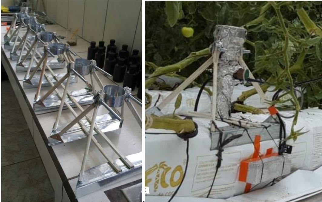
**Figura 19.** Estructura de soporte de los tensiómetros (a) instalados en el contenedor de fibra de coco (b) que fue colocado en la CDI con cultivo. (Estructura diseñada por Julio Vega)
