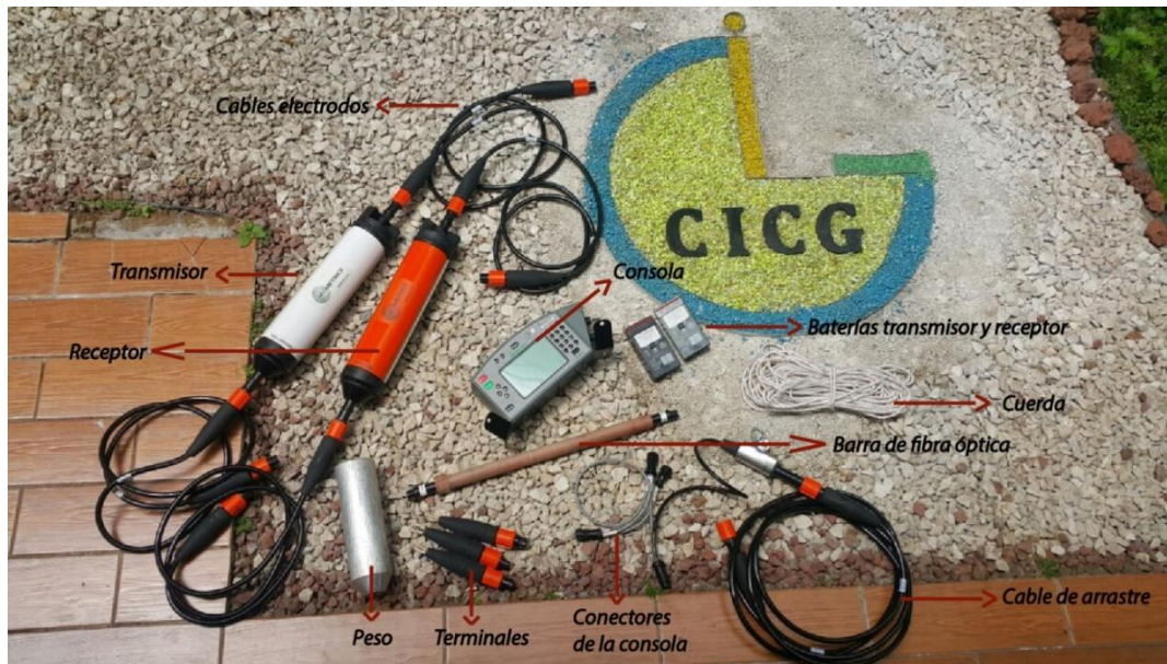
Fotografía 6: Instrumento Ohmmapper y sus componentes
