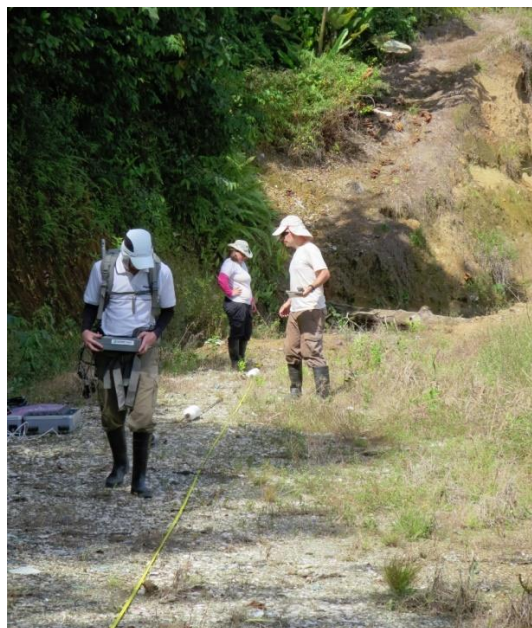
Fotografía 7: Utilización del instrumento Ohmmapper como parte de la prospección geofísica en el botadero de basura de Golfito.
