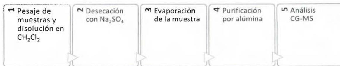
Figura 15. Pasos seguidos para la preparación de las muestras de búnker en el análisis de muestras ciegas.
