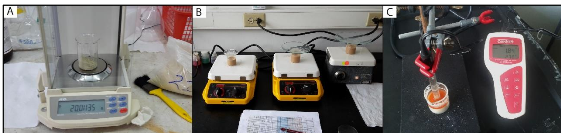
Figura 12. Procesado de muestras en el Laboratorio de Geoquímica de la Escuela Centroamericana de Geología UCR. A. Pesado de muestras en balanza analítica. B. Agitación de muestras con agua, pastilla metálica y agitador eléctrico C. Medición electroquímica con pH-metro.
