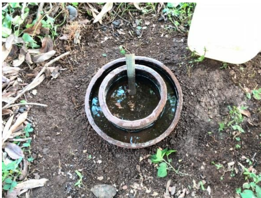
Fotografía 1. Prueba de infiltración mediante el método del doble anillo, realizada en la localidad de Canoas, coordenadas CRTM05: 478365 E / 1109656 N.
