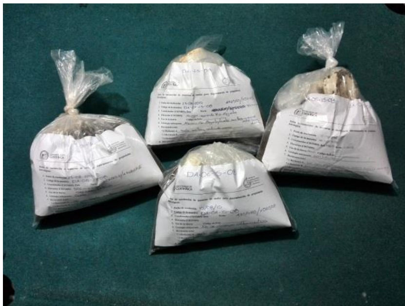
Fotografía 2. Muestras de suelo recolectadas en campo y debidamente rotuladas previo a su ingreso al INTA para la realización de los ensayos de laboratorio correspondientes.
