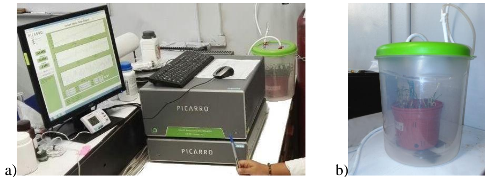
Figura 5. Equipo utilizado para la medición de gases. a) Espectrómetro de cavidad de decaimiento para el análisis isotópico de N_2O . b) Sistema de cámara estática operando bajo flujo cerrado que se utilizó para la medición del flujo simultáneo de N_2O y ^{15}N_2O .
