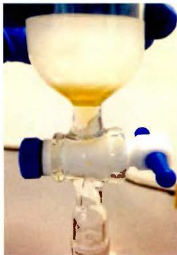
Figura 3-9 Fotografía de la extracción de los analitos en el RTU con diclorometano.
