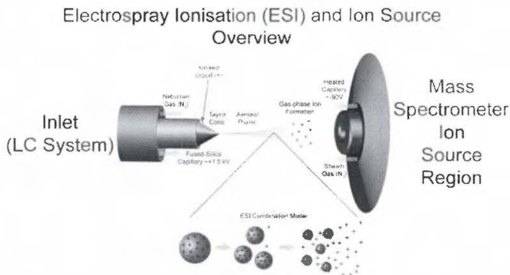
Figura a.9. Técnica ESI (electronebulización ó electrospray) 84-86 .
