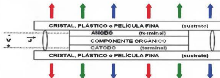
Figura 1.5. Estructura básica desarrollada por Ching Tang y Steve van Slyke de un diodo electroluminiscente orgánico (OLED) 12,13 .
