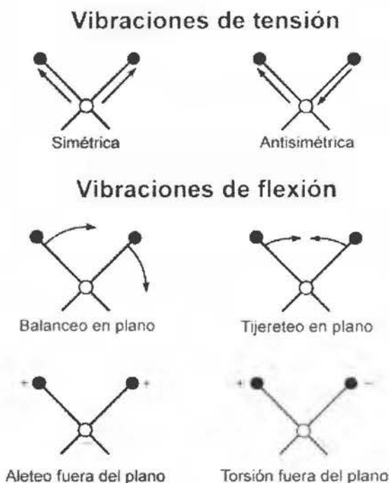
Figura a.1. Modos vibracionales de los enlaces moleculares durante el análisis por infrarrojo 80,81 .
