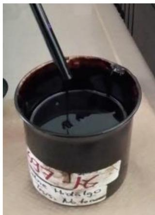
Figura 8: Punto hilo del asfalto AC-30 después de su calentamiento para la manipulación y pesaje.
