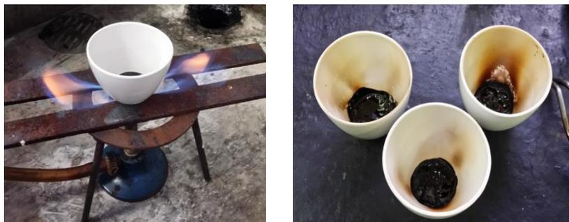
Figura 12: Eliminación de vapores de la muestra de asfalto AC-30 por calentamiento con mechero Bunsen.
