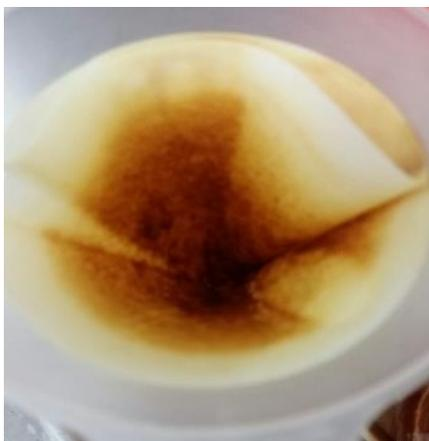
Figura 10: Papel filtro con partículas de muestra de asfalto AC-30 presentadas en el procedimiento A de digestión por multietapas por microondas.
