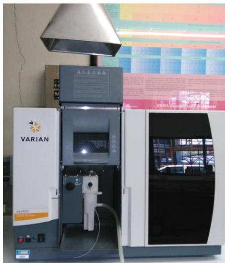
Figura 5: Espectrofotómetro de absorción atómica.
