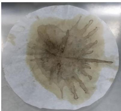
Figura 16: Papel filtro de una muestra de asfalto diluida con *mineral spirits*.
