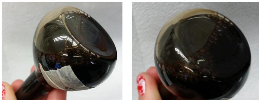
Figura 17: Verificación visual de partículas de asfalto AC-30 en las paredes del balón aforado.
