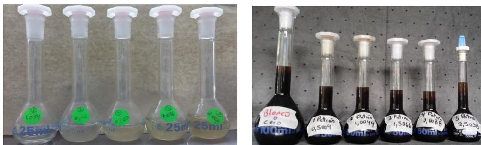
Figura 7: Patrones de calibración en *mineral spirits* y en matriz de asfalto AC-30 para la medición de V, Ni, Zn y Fe en muestras de asfalto por EAA
