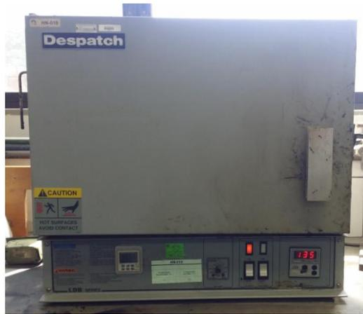
Figura 4: Horno para calentamiento de muestras de asfalto en el Lanamme UCR.
