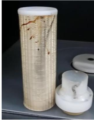
Figura 11: Tubos de microondas destruidos por explosión en el procedimiento de multietapas para la digestión de muestras de asfalto AC-30.
