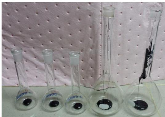
Figura 13: Muestreo de asfalto AC-30 en balones aforados.
