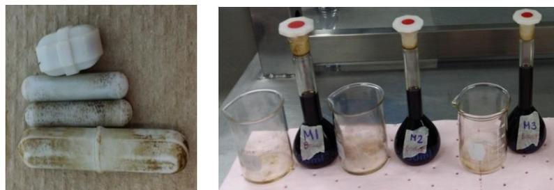
Figura 15: Pastillas magnéticas y beakers manchados por una muestra de asfalto AC-30 diluida en *mineral spirits*.
