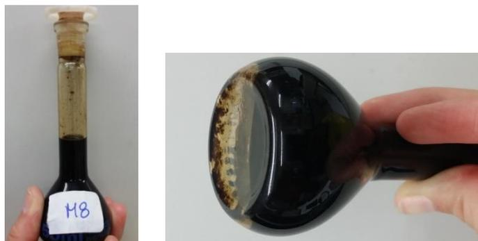
Figura 18: Partículas de asfalto AC-30 visibles, no disueltas en el solvente orgánico *mineral spirits*.
