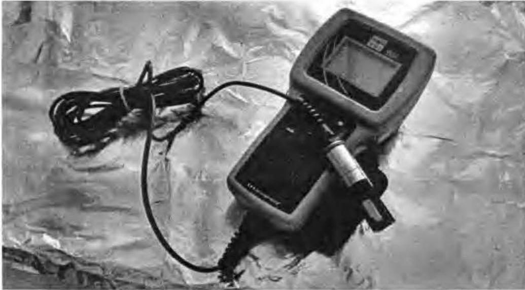
**Figura 9. Equipo YSI Environmental Modelo 550 A para la determinación de oxígeno disuelto. Foto tomada el día 13 de octubre del 2012 por Andrés Zamora Q.**
