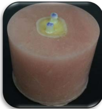
Ilustración 5. Cilindros de resina cementados a superficie dentinaria
