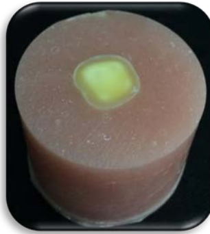
Ilustración 4. Cilindro de acrílico con pieza dental embebida
