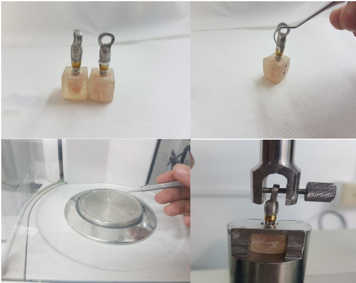
Figura 12. Comparación técnica con y sin preasentamiento, remoción de exceso, pesaje de exceso y fuerza de tracción 24 horas después de la cementación. Fuente: Elaboración propia, 2017.
