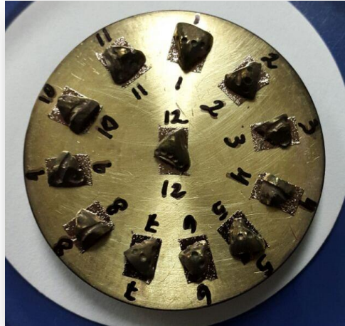
Figura 5. Muestras previo a observación en el microscopio electrónico con el baño de Oro-Paladio.
