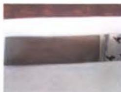
**Figura 17.** Placa GV-YCG-097, placa de titanio metálico anodizada en fluoruro de amonio en etilenglicol a 30V durante 2 horas y 21 minutos.
