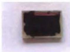
**Figura 11.** Placa de vidrio conductor GV-YCG-095 con película de 1400Å de titanio metálico después de realizar la oxidación con temperatura.
