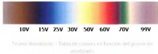
**Figura 7.** Tabla de colores según el voltaje utilizado durante el anodizado, a mayor voltaje, mayor grosor de la capa de óxido.<sup>23</sup>
