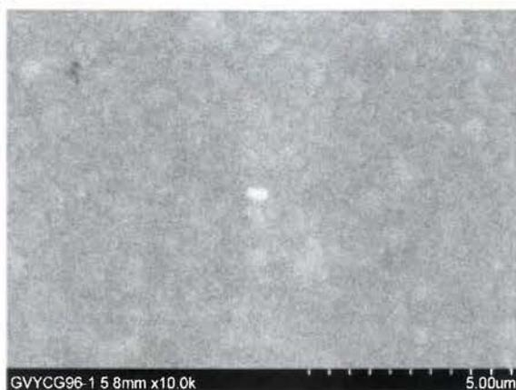
**Figura 56.** Imagen SEM de la placa GV-YCG-096 después de usarse a un acercamiento de  $5.00\mu\text{m}$ .
