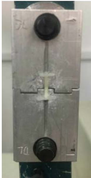
Figura 10. Muestras dentinales sometidas a tensión en equipo Tinius Olsen.
