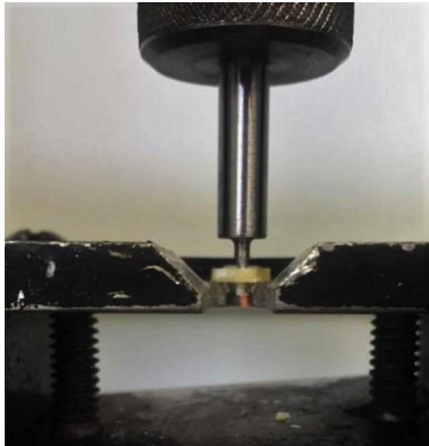
**Figura 4.** Prueba de Resistencia al desplazamiento-Push-out en la máquina Universal de Ensayos.
