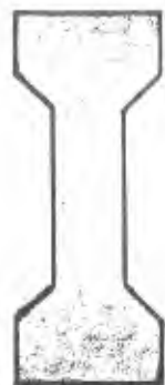
a) Viga I
