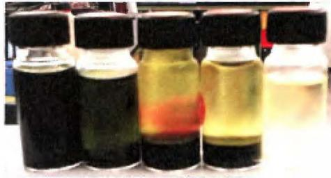
**Figura 5.** Proceso de eliminación de pigmentos utilizando carbón activado como adsorbente.
