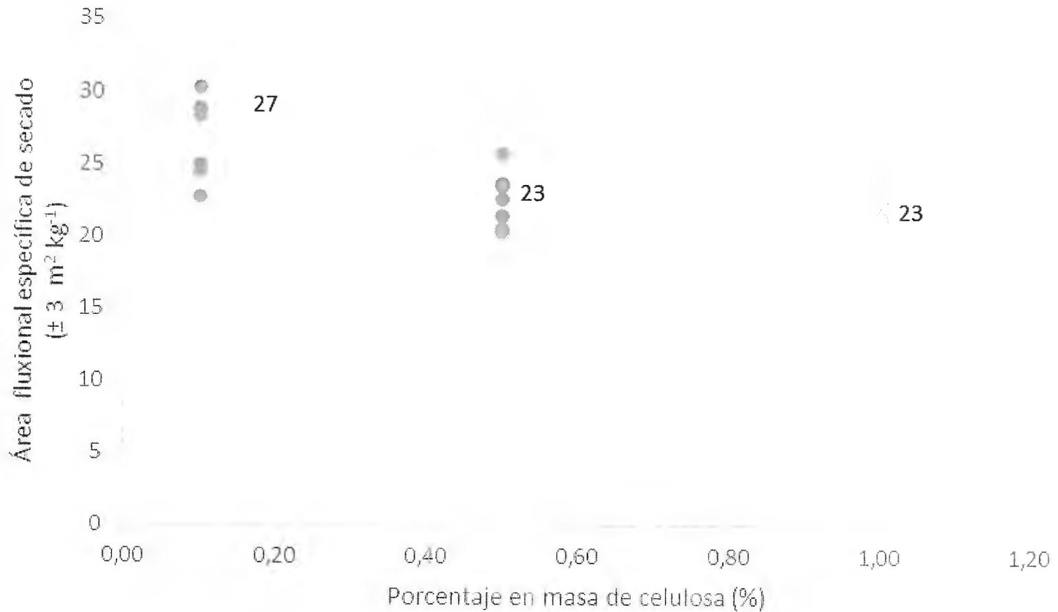
**Figura 17.** Variación del área fluxional específica de secado en función del contenido de celulosa añadido a la placa de cemento, determinada a 50 °C, en balanza de humedad.
