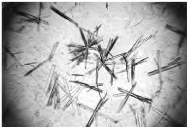
Figura N°14. Sustancia extraída disuelta en metanol caliente, y evaporando éste por medio de calor.
