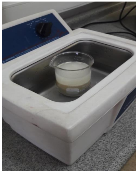
Figura 12. Ultrasónico para agitar la mezcla del sésamo con el solvente
