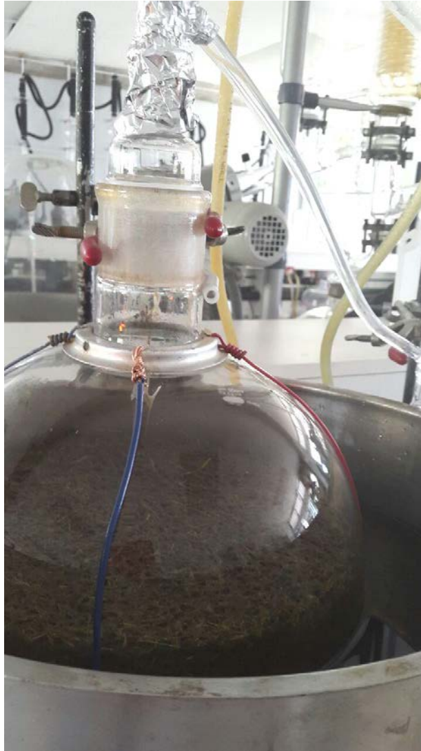
Figura 14. Mezcla de tomillo contenida en balón suspendido en glicerina al 100 °C – 120 °C.
