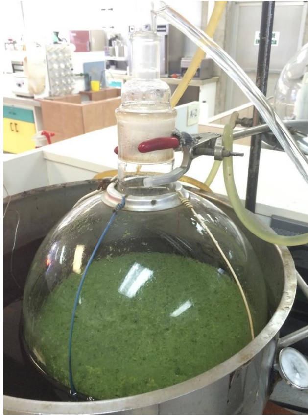
Figura 5. Mezcla de ciprés contenida en balón suspendido en glicerina al 100 °C – 120 °C.
