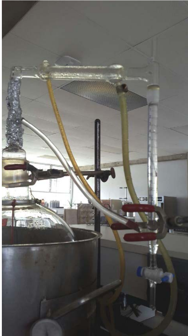
Figura 13. Equipo de arrastre al vapor para extracción de aceite esencial de tomillo.
