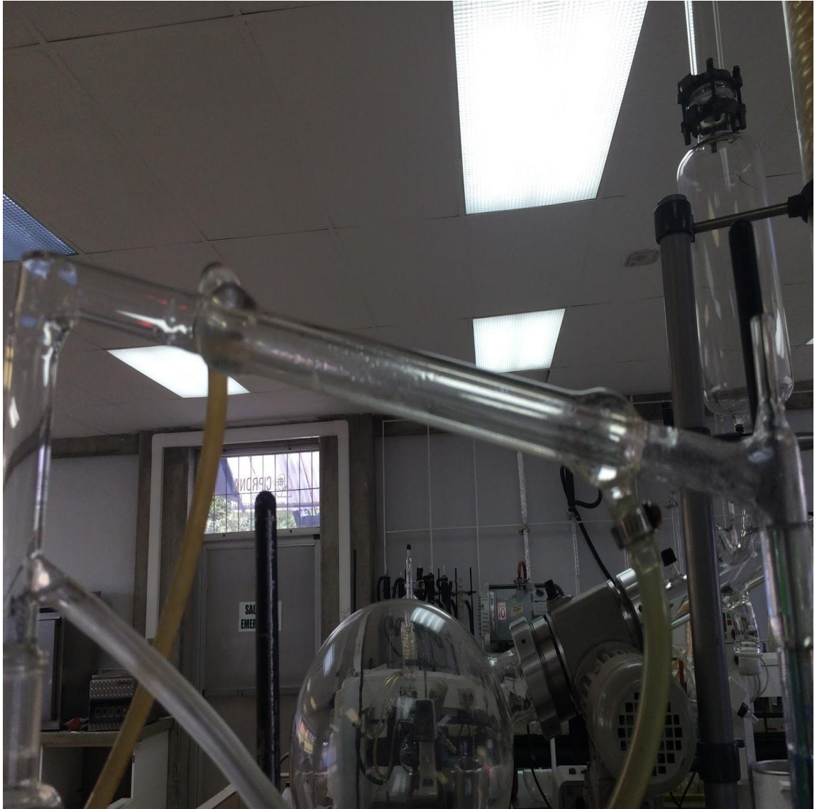
Figura 6. Condensador del equipo de extracción de aceite esencial de arrastre al vapor.
