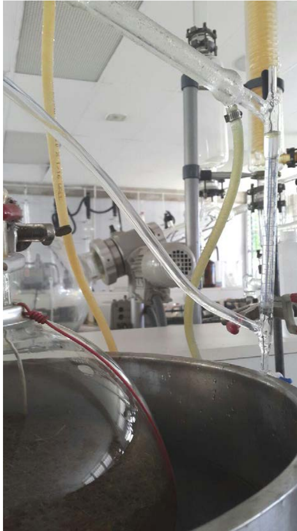
Figura 15. Condensador del equipo de extracción de aceite esencial de arrastre al vapor.
