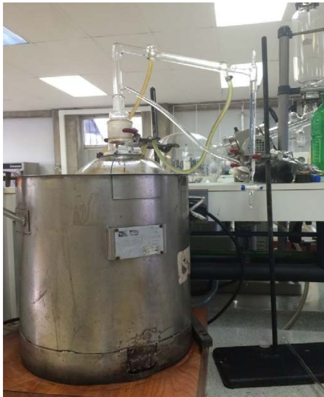
Figura 4. Equipo de arrastre al vapor para extracción de aceite esencial de ciprés.
