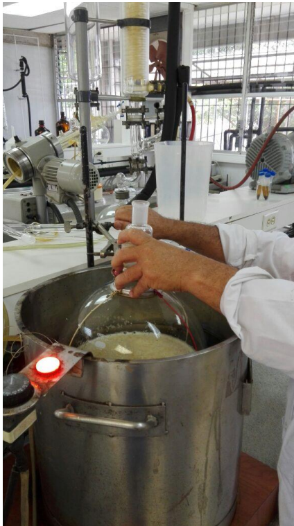
Figura 5. Sistema de calentamiento con glicerina (100°C-120°C) para la extracción del aceite esencial del jengibre.
