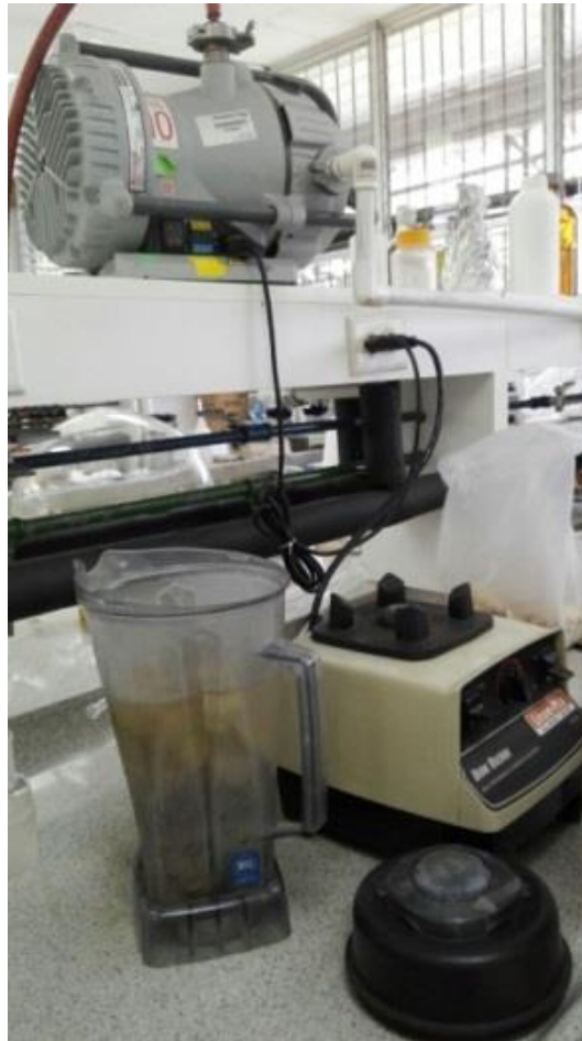
Figura 3. Equipo utilizado para licuar el jengibre junto con agua destilada (3500 mL) para la extracción del aceite esencial de jengibre.
