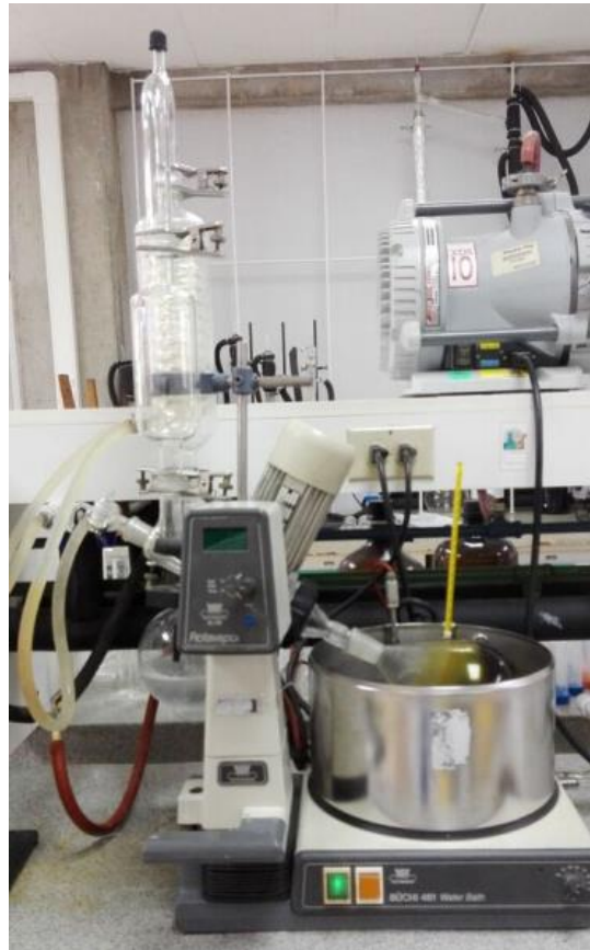
Figura 14. Equipo Rotavapor, el cual logra la separación del solvente etanol.
