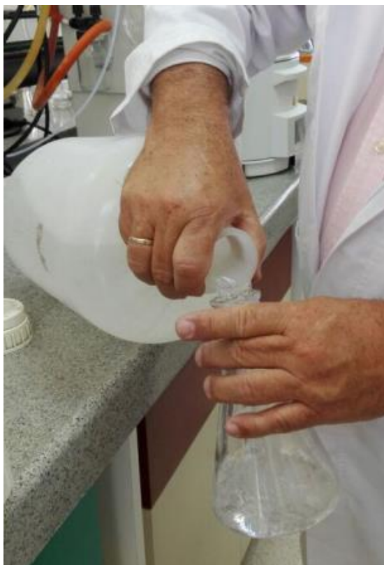
Figura 11. Solvente etanol utilizado para la extracción del extracto de pimienta negra (600mL).
