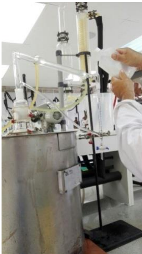
Figura 6. Sistema de hidrodestilación para la extracción del aceite esencial de jengibre.
