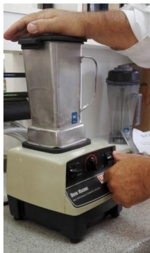
Figura 10. Equipo utilizado para moler los granos de pimienta negra para la extracción del extracto de pimienta negra.
