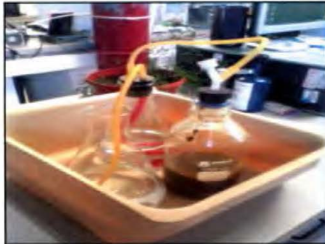
Figura 5. Prototipo del biodigestor utilizado.
