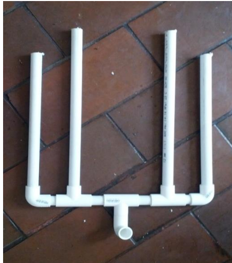
Figura 5.4 Sistema de distribución de flujo de los reactores UASB
