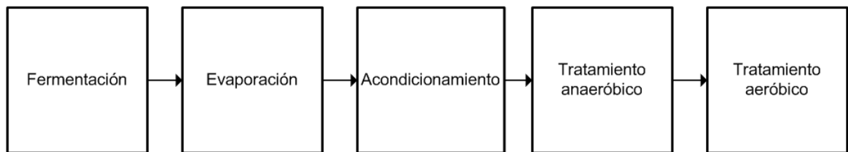
Figura 5.1 Esquema de las etapas de la planta piloto de tratamiento de vinazas
