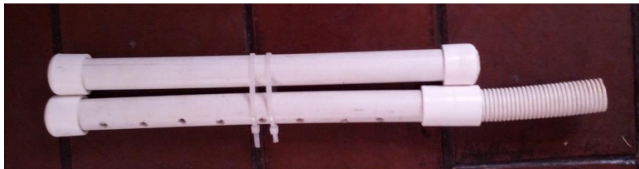
Figura 5.5 Flotador para la salida de los reactores UASB
