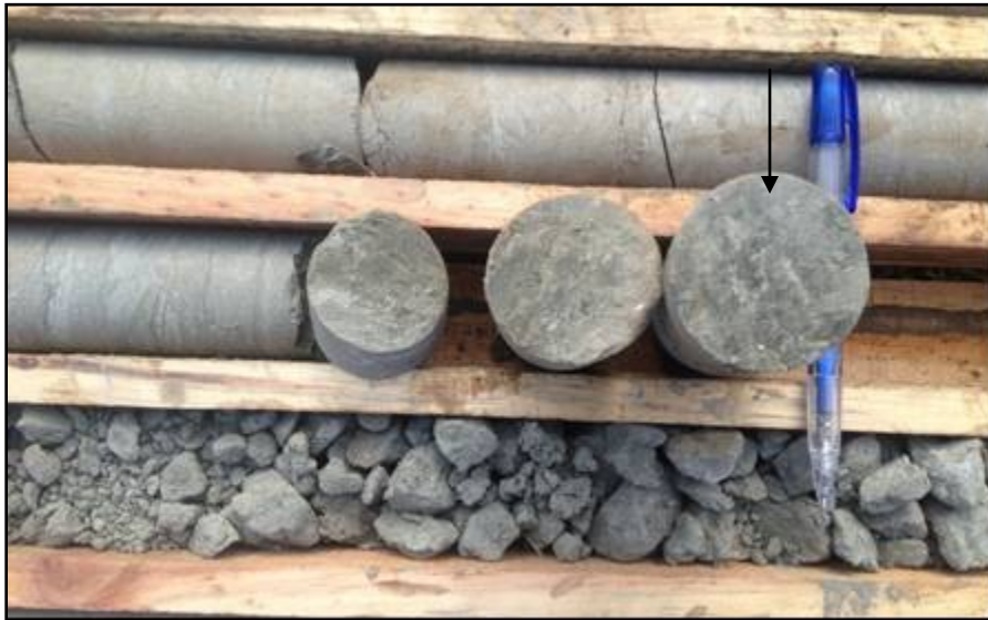
Figura 2.7. Superficies estriadas en testigos de perforación. Fuente: Michael Calderón Q
