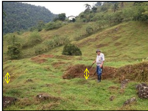
Figura 3.19. Desplazamientos verticales (coronas). Coordenadas Este: 541868 Norte: 1111749 Fuente: Michael Calderón Q
