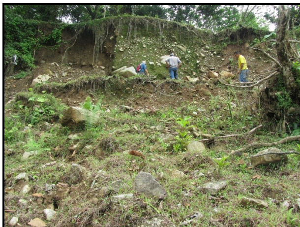
Figura 3.6. Corona de deslizamiento actual sobre margen izquierda hacia el río Blanco. Coordenadas Este: 542147 Norte: 1110828 Fuente: Michael Calderón Q
