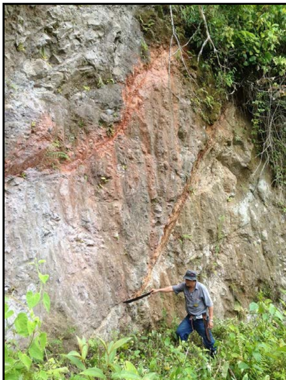
Figura 2.10. Brechas volcánicas con clastos sub angulosos con fracturas rellenas de arcillas rojizas Coordenadas E: 541262, N: 1110238. Fuente: Michael Calderón Q
