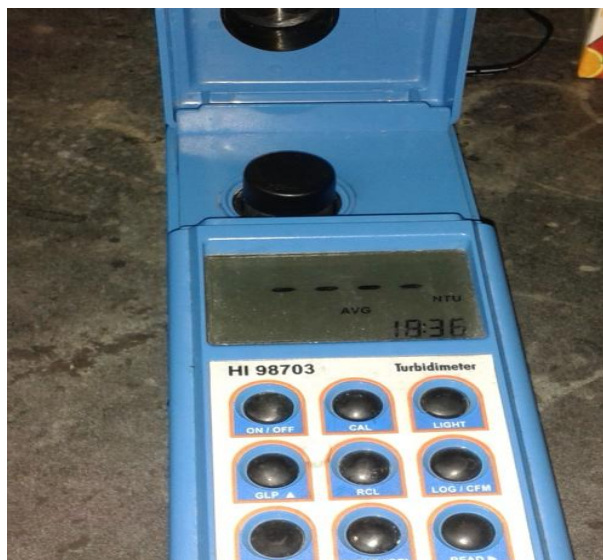
Figura 5.5 Colocación del vial dentro del turbidímetro.
