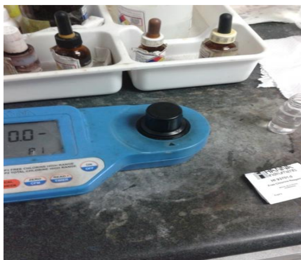
Figura 5.13 Colocación del vial dentro del colorímetro con su cubierta de luz.
