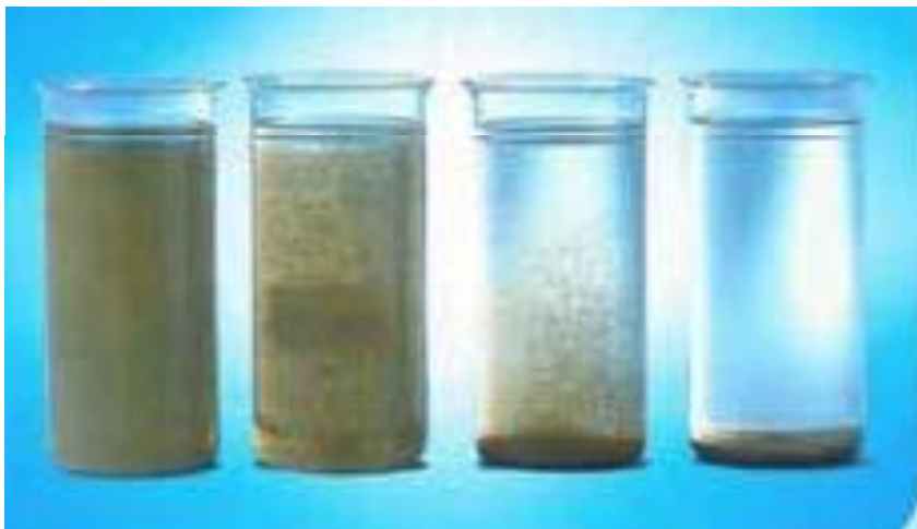
Figura 1.5 Proceso de sedimentación. (www.plantaspurificadorasdeagua.net, 2013)
