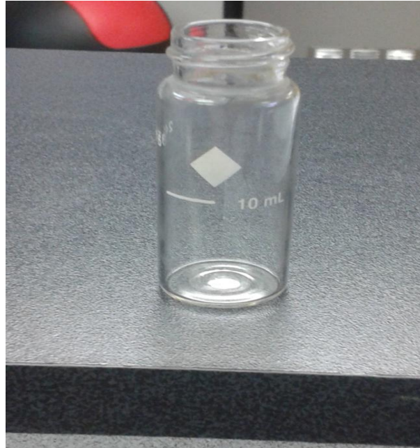
Figura 5.4 Celda de muestreo (vial) utilizada con el turbidímetro Hanna.
