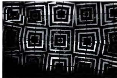
Imagen 2.19 Ejemplo de un patrón geométrico sistema de tres espejos, isósceles, 45^\circ - 45^\circ - 90^\circ
