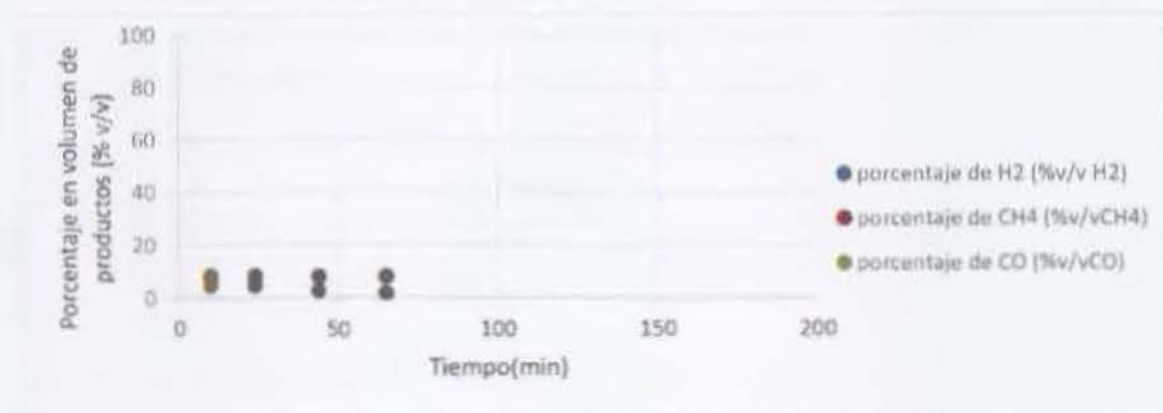
Figura 39. Representaciones de los porcentajes en volumen de productos de reacción de la reacción de reformado ( T_{\text{reacción}} (723 \pm 5) \text{ K} ), con arrastre mediante ebullición de mezcla 1:3 EtOH:H 2 O, utilizando como catalizador el NiO, soportado en alúmina, catalizado a 773 K.
