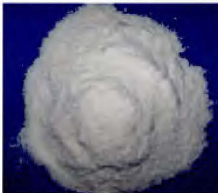
Figura 12. Fotografía de los polvos de desechos de Extralum luego de ser procesados mecánicamente y secados en horno por 12 h a 383 K.
