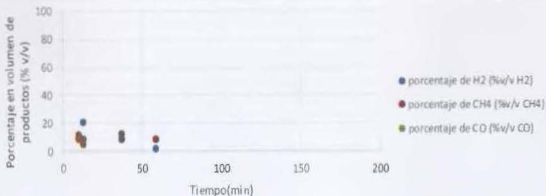
Figura 34. Gráficas de porcentajes en volumen de productos de reacción de la reacción de reformado ( T_{reacción} (723\pm 5) K ), con arrastre mediante ebullición de mezcla 1:3 EtOH:H 2 O, utilizando como catalizador el Co 3 O 4 soportado en alúmina y calcinado a 573 K.
