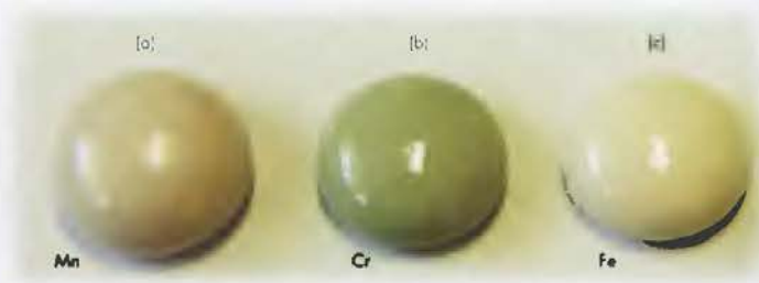
Figura 7. Muestras de pigmentos sobre placa, obtenidos a partir de los lodos residuales del proceso de anodizado. Desarrollo de color, de: (a) MnO_2 , (b) Cr_2O_3 y (c) Fe_2O_3 al 15% m/m. (Gomes, V.; Labrincha, J., 2005)
