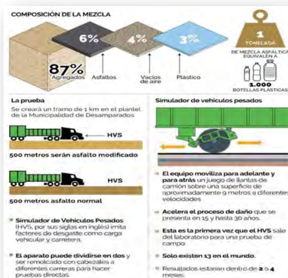
Figura N° 2. Composición de la mezcla en el asfalto verde 11
