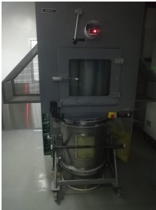
Figura 4. Horno de lecho fluido en funcionamiento.
