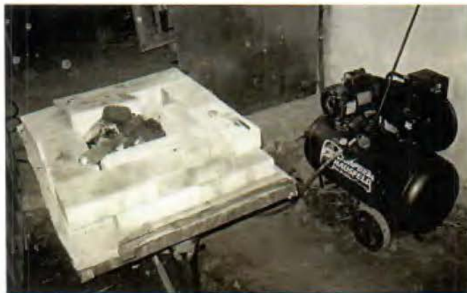
Compresor conectado a la fragua para avivar el fuego.
