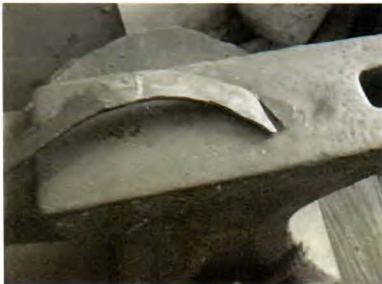
Pieza de acero cortada con el triscador
