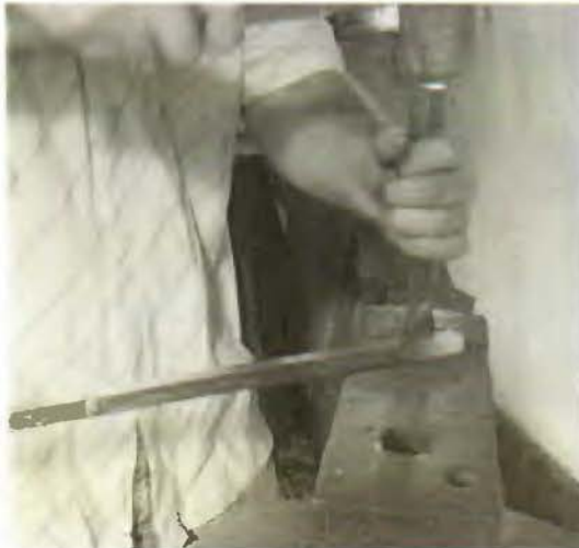
Pieza sujeta con ayuda de un asistente
