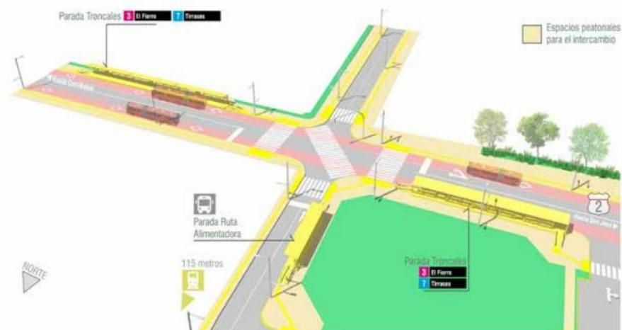
Figura 10. Diseño de infraestructura física del nodo de integración Parque Kennedy
