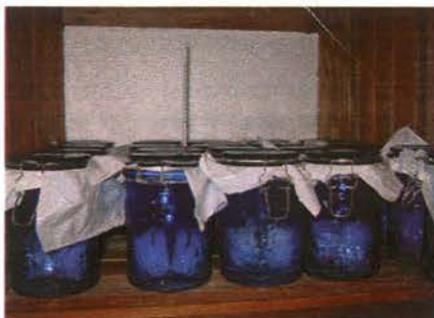
Figura 14. Técnica de incubación del suelo para determinación de la respiración microbiana.
