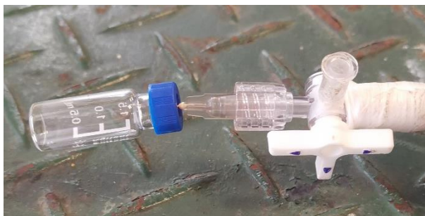
Figura 6. 10. Formación de vacío en el vial para la inyección de la muestra gaseosa.
