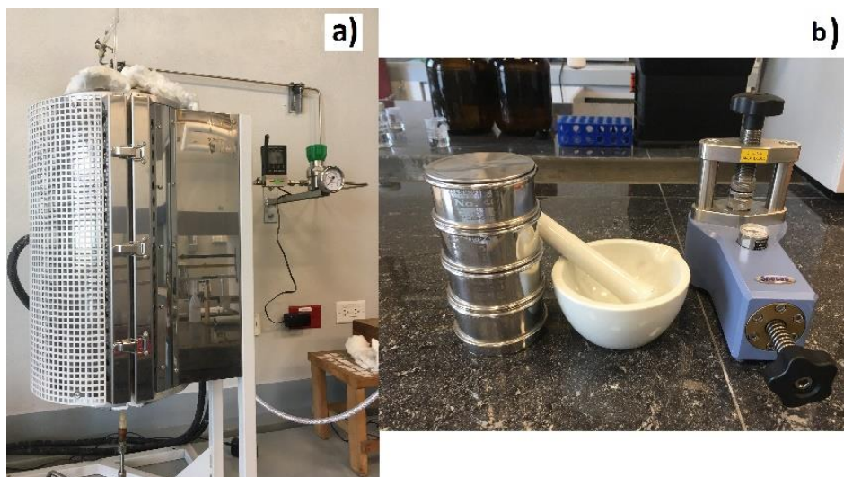
Figura 6. 6. Reducción de catalizadores: a) sistema de reducción de catalizador y b) equipo para formación de pastilla.
