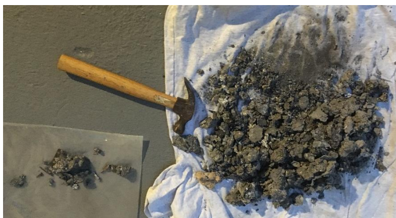
Figura 7. 2. Proceso de eliminación de piezas más duras de la escoria de aluminio.
