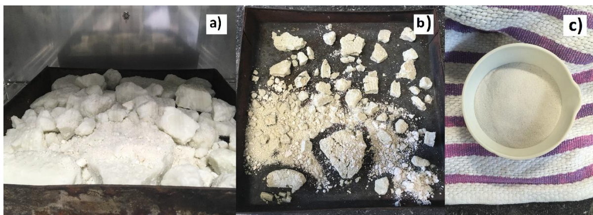
Figura 6. 4. Obtención de alúmina a partir de lodos residuales: a) lodos sin tratar, b) lodos secos y c) lodos tamizados y calcinados a 750 °C.
