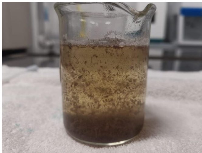
Figura 7. 17. Licor de reacción de la prueba utilizando el glicerol purificado de la empresa Recope.
