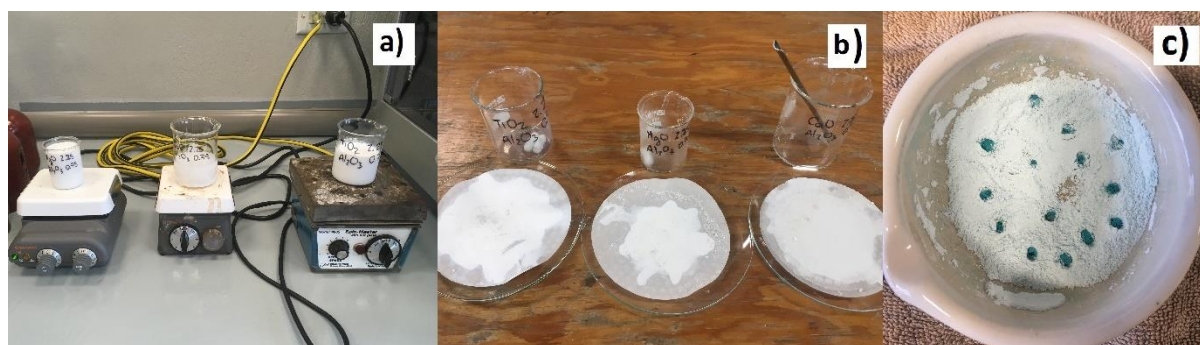
Figura 6. 5. Preparación de catalizadores: a) mezcla de soportes con agitación, b) filtración de soportes y c) impregnación de soportes con \text{Cu}(\text{NO}_3)_2 \cdot 2,5\text{ H}_2\text{O} .
