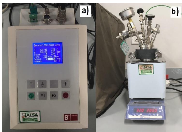
Figura 6. 7. Sistema de reactor con controlador de calentamiento para las reacciones: a) condiciones de reacción en el controlador y b) reactor cargado en la plantilla de calentamiento.
