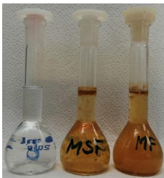
Figura 7. 23. Disoluciones luego de acidificadas para el análisis ICP-OES.
