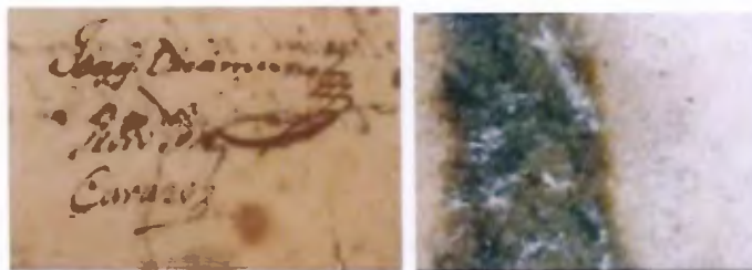
Figura 8. Detalle de foxing, zonas con pérdida de material, y detalle al microscopio de corrosión por la tinta.
