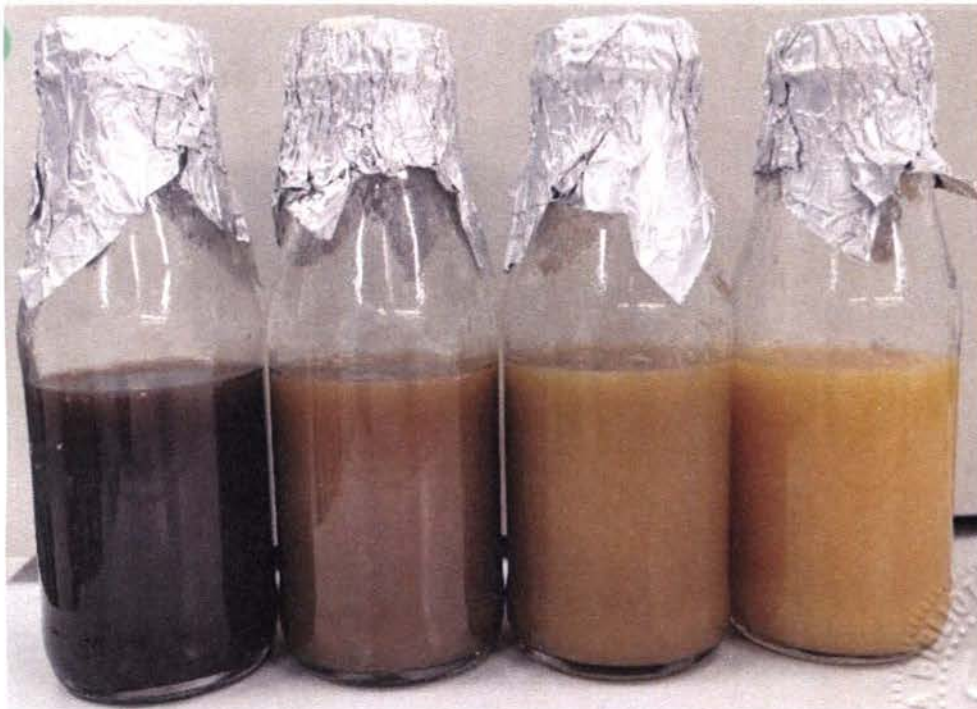
Figura 15. Cambio de color experimentado en las mezclas de jugo de naranja-mora (50, 25 y 12,5% mora, de izquierda a derecha, respectivamente) inoculadas con A. acidoterrestis e incubadas por 28 días a 45°C.
