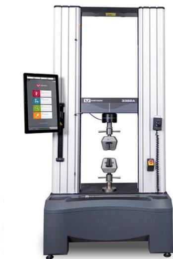
**Figura 8.** Equipo utilizado para las pruebas de esfuerzo de acoplamiento y esfuerzo cortante de acoplamiento (Direct Industry, 2023).
