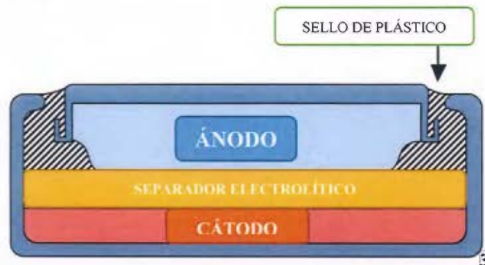
Figura 1. Corte transversal de una batería de botón.
