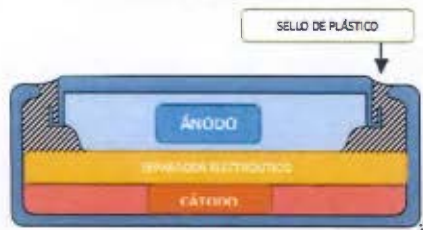
Figura 3. Corte transversal de una batería de botón
