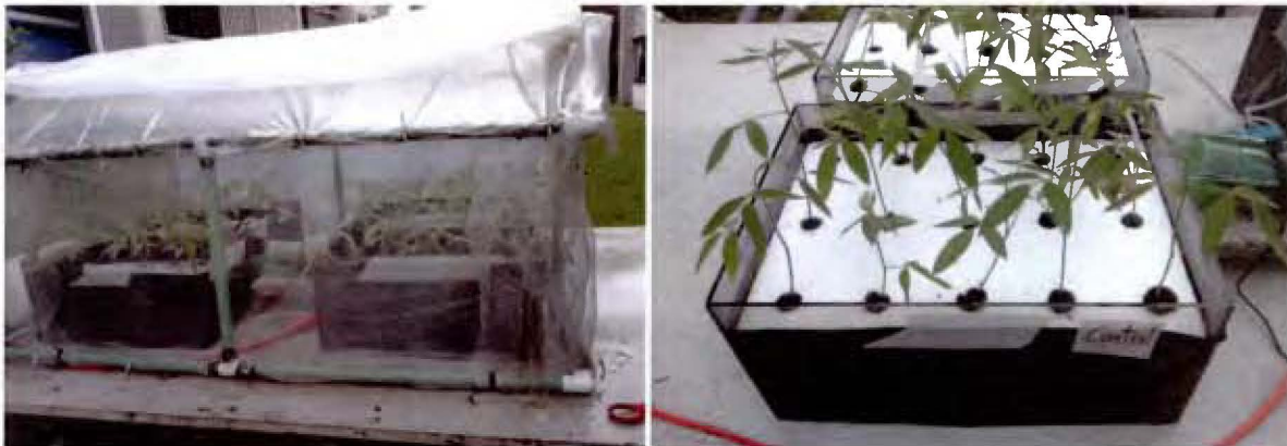
Figura 10. Sistema de remoción de metales en hidroponía. Se presentan los cuatro sistemas en la estructura utilizada (izquierda) y los sistemas individuales (derecha). Cada sistema contiene 15 plantas.
