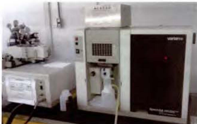
Figura 6. Equipo de absorción atómica Varian, modelo 220.
